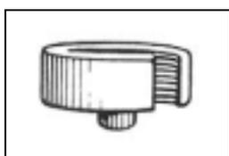
O anel é um elemento de porcelana com rosca interna, cuja função é proteger a rosca metálica da base aberta, pois evita a possibilidade de contatos acidentais na troca do fusível.
