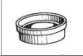
O fusível é um dispositivo de porcelana em cujas extremidades é fixado um fio de cobre puro ou recoberto por uma camada de zinco. Ele fica imerso em areia especial cuja função é extinguir o arco voltaico e evitar o perigo de explosão quando da queima do fusível.
