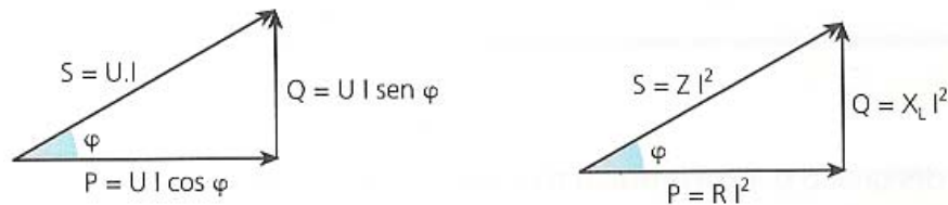
Figura 12.2 - Triângulo das potências num circuito RL
