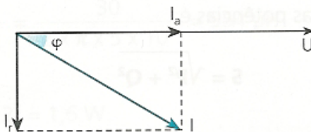
Figura 12.1 - Componentes activa e reactiva da corrente
