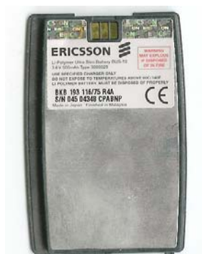
Figura 5.8 - Célula de polímeros de lítio utilizada em telemóveis
